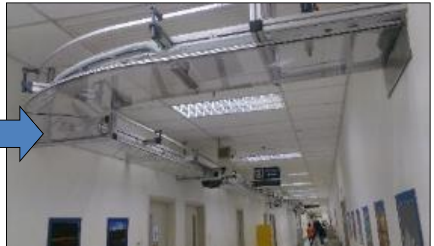
Penggunaan "overhead conveyor" untuk memindahkan produk ke bahagian pembungkusan
