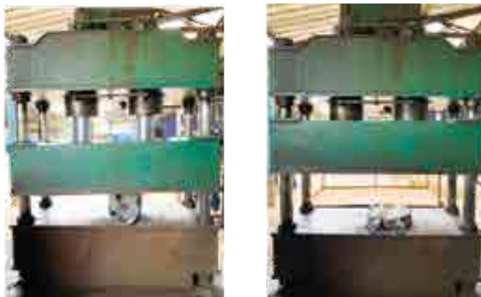
**Rajah 7:** Silinder dileperkan untuk pelupusan
