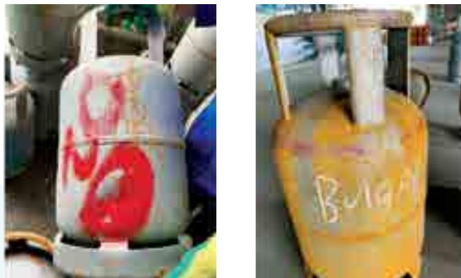
**Rajah 6:** Contoh silinder yang tidak selamat untuk digunakan
