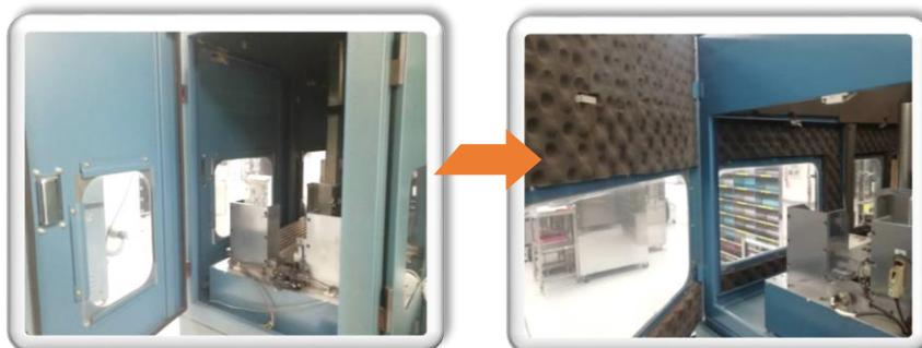
Pemasangan *acoustic foam* pada dinding dalam mesin (*Insulation*) dan dapat mengurangkan paras bunyi sebanyak 5dB(A).
