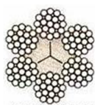
Core type : Fibre Classification : 6 x 19
