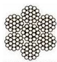
Core type : Strand Classification : 6 x 19
