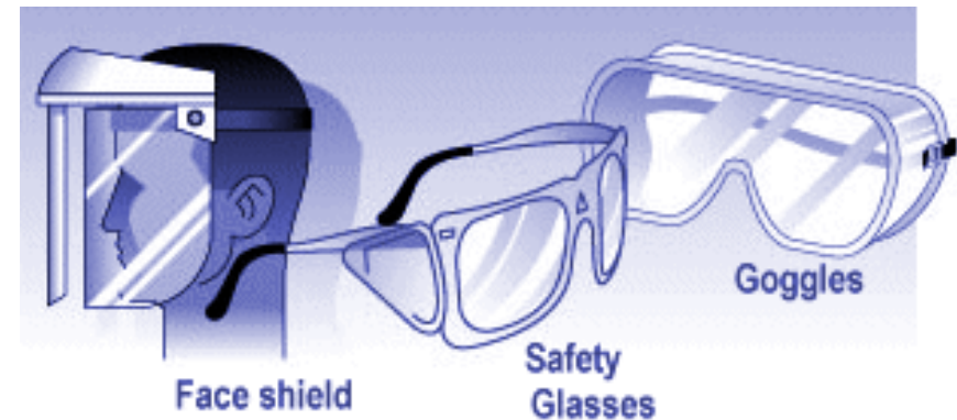
Rajah b menunjukkan tiga jenis alat pelindungan mata iaitu pelindung muka, cermin mata keselamatan dan gogal.
