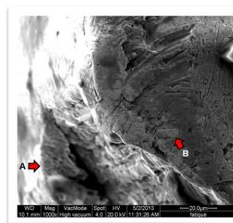
Rajah menunjukkan imej mikroskop pengimbas elektron (SEM) yang menunjukkan sirip (ditanda A), dan B adalah tempat permulaan retakan dan anak panah B menunjukkan arah perambatan retak lenturan lesu.
