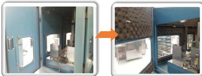
Pemasangan *acoustic foam* pada dinding dalam mesin (*Insulation*) dan dapat mengurangkan paras bunyi sebanyak 5dB(A).
