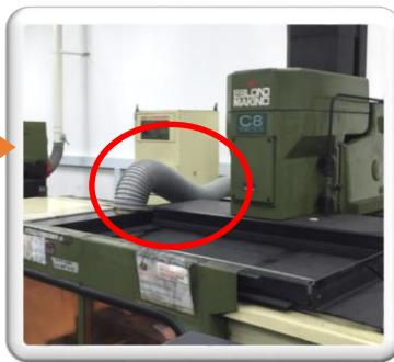
Pemasangan salur kebuk sistem pengalihudaraan setempat yang disambungkan dengan ekzos untuk mengurangkan habuk dibebaskan ke udara.
