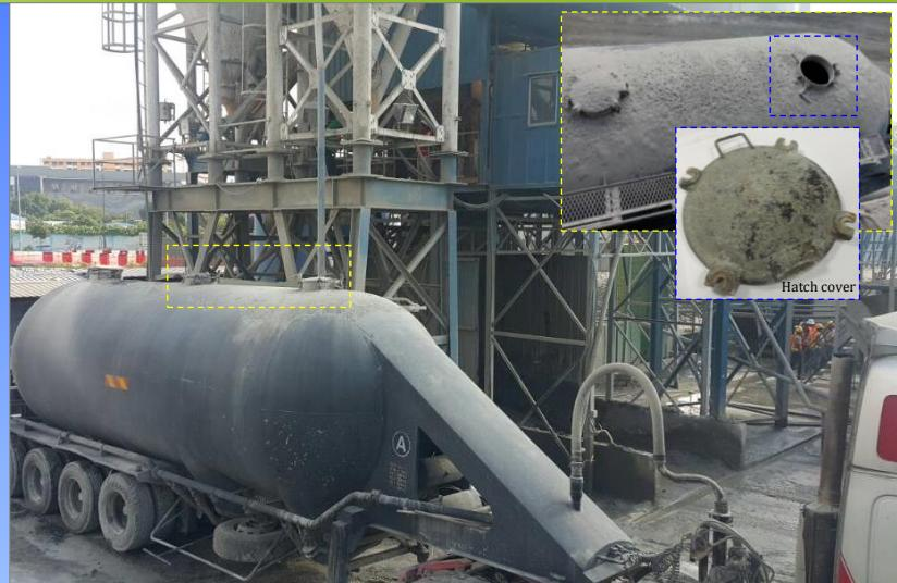
Seorang pemandu/operator *tanker* simen mengalami kecederaan setelah salah satu *hatch cover* yang terletak di atas *tanker* tersebut tercabut dan menghentam mangsa. Impak hentaman telah menyebabkan mangsa terjatuh dari atas *tanker*. Sejurus sebelum kejadian, mangsa sedang membuat pelarasan pada *hatch cover* terbabit.
